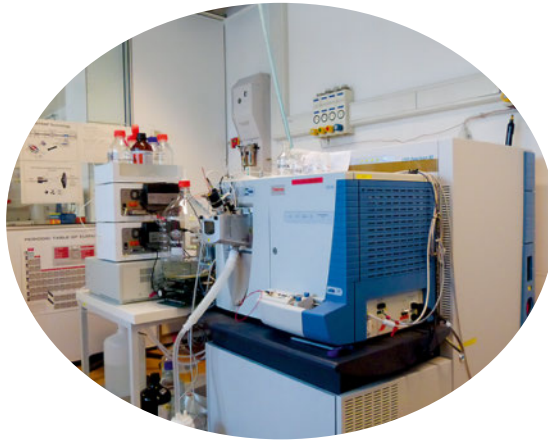
Das Gebäude der Rheinüberwachungsstation (RÜS) in Weil (links). Das hochauflösende Massenspektrometer (HPLC-HRMS), mit dem die Tages-Sammelproben analysiert werden (unten).
